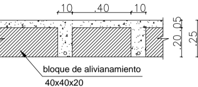
CORTE LOSA e=25cm
